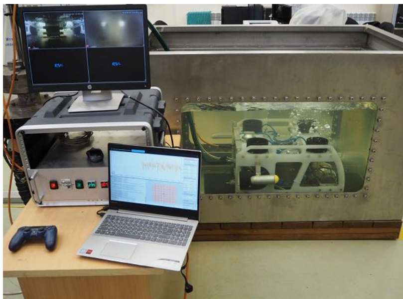
Рис. 2. Внешний вид изготовленного «Макета аппарата лазерной подводной очистки поверхности объектов от биообрастателей»
